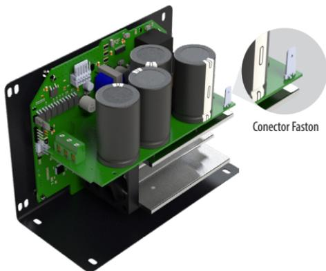
Este inversor possui rampa própria adequado para motores 220V 60HZ, todos os motores que estiverem dentro dessa curva podem ser utilizados. Abaixo é mostrado a curva V/F para este inversor.
